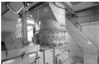
回転式破碎機 粗破碎機で破碎したごみを、より細かく破碎し選別しやすくする
