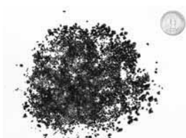
灰熔融炉で灰を1,500℃の高温で溶かし、有効利用できるスラグ(建築資材)・メタル(金属)を作る
