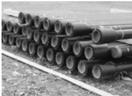
耐震性の水道管 (ダクトイル铸铁管)
