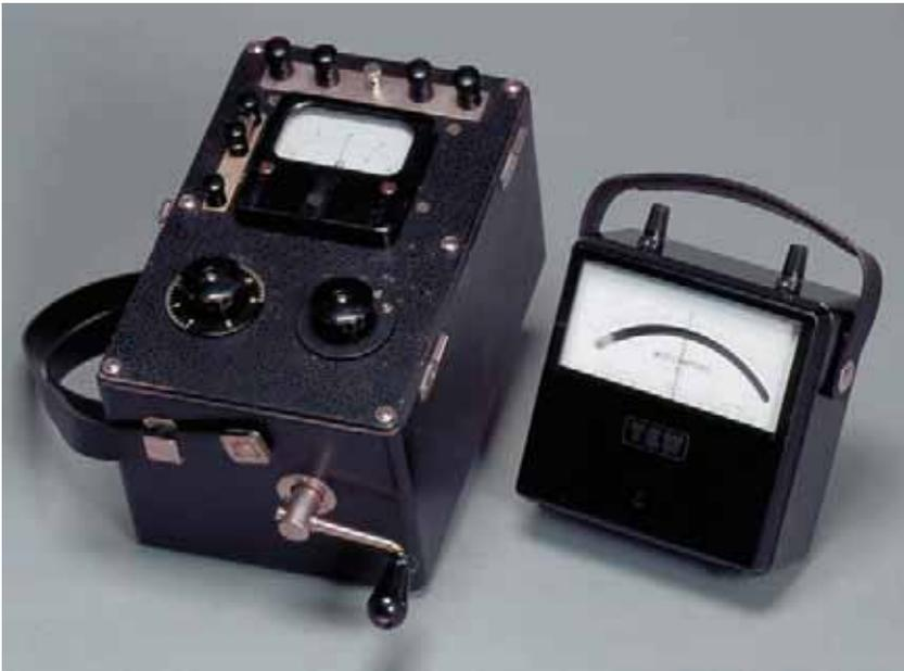
地下水の調査で使用された電気探査機
